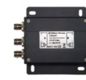
CSA221 패시브 컴바이너/스플리터 - 470-960 MHz - 무선마이크 시스템과 연결 사용 - 삽입 손실: 4 dB - 최대 입력 신호: 125 mW - 20 x 100 x 126 mm (HxWxD), 220 g
