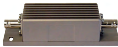
PAW 와이드밴드 MFL 안테나 앰프 - 435-698 (PAW-L), 470-960 MHz (PAW-X) - 증폭 (Max.): 20 dB - 120 x 48 x 29.5 mm, 230 g
