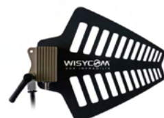
LBP-LNP 액티브 와이드밴드 IEM/IFB 안테나 - 435-1300 MHz - 6 dBi, 지향각 90°, SWR 1:1.2 - 부스터 증폭: Max. 20 dB
